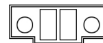
Fig. 16. Barra para ligação ao contacto auxiliar do quadro de bypass manual ( paragem inversor ).
