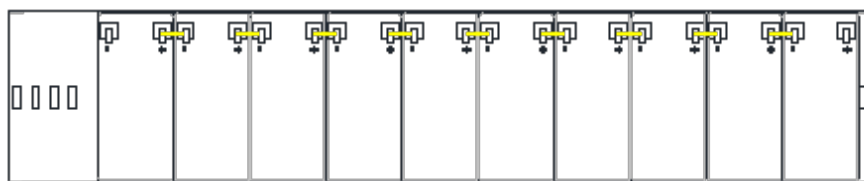
Fig. 28. Vista superior de una fila de baterías (12 V, 7-9-11 Ah).
