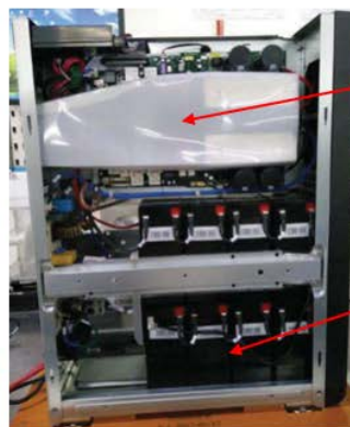
CANALIZADOR AIRE / AIR DUCT
