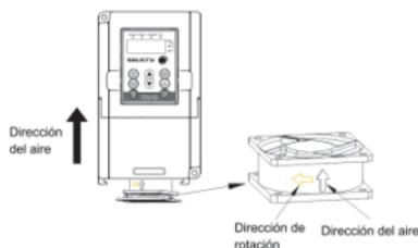
Ilustración del cambio de ventiladores en los variadores
