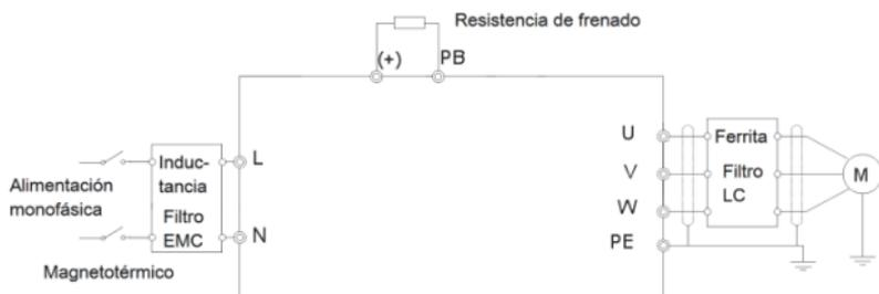
Figura 3-3 Diagrama de conexión del circuito principal
