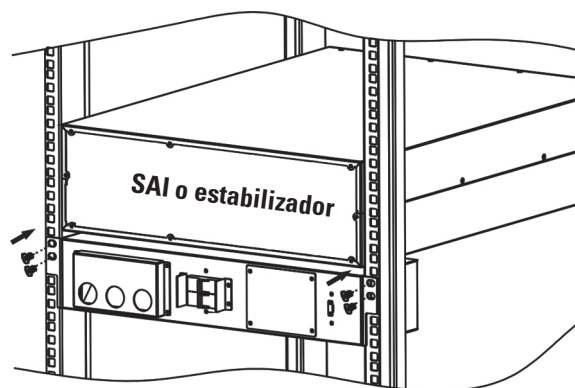
Fig. 6. Ejemplo montaje bypass manual de 6 y 10 kVA.
