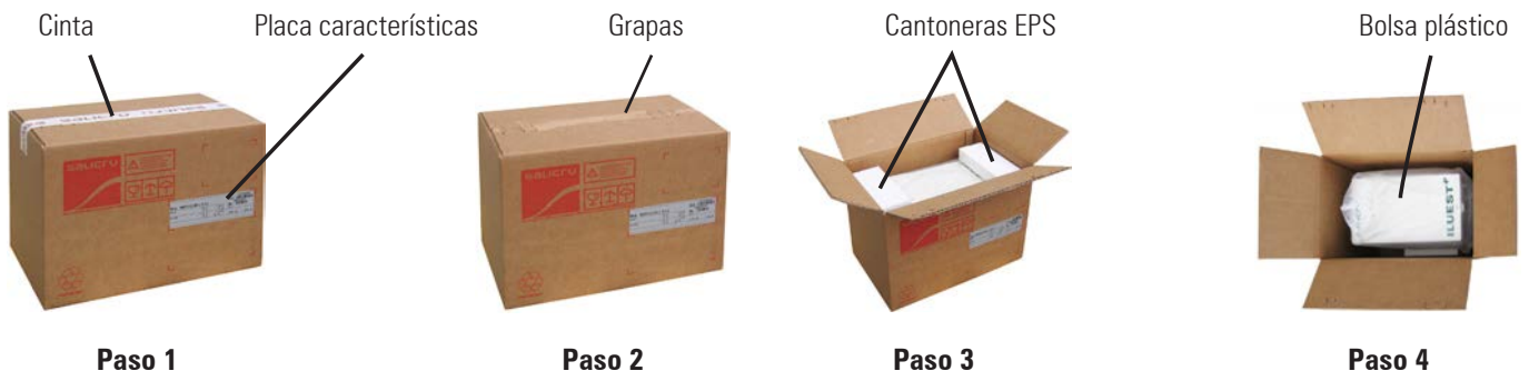
Fig. 12. Proceso de desembalaje módulo (OEM).
