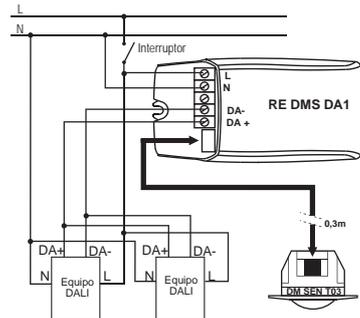
**Nota:** al alimentar el regulador, después de un apagado, las lámparas se encenderán a su nivel máximo.
