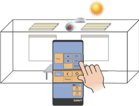
2° - En caso de no ser suficiente el aporte de luz natural, encender las luminarias con la tecla ON y regularlas al nivel requerido para obtener la iluminación deseada en el puesto de trabajo.
