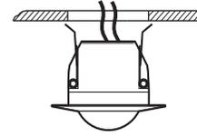
Realice el cableado según el Punto 5 e introduzca el sensor en el orificio realizado previamente.
