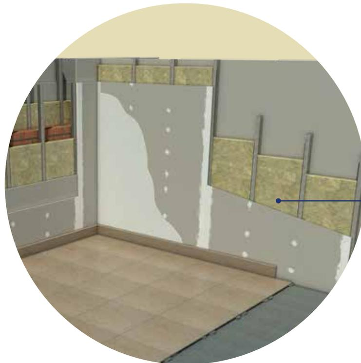
Los cerramientos con entramado metálico y **URSA TERRA** basan su eficacia acústica en el sistema masa-muelle-masa. La lana mineral actúa como un atenuador de la vibración acústica que permite alcanzar en poco espacio un óptimo aislamiento acústico.
