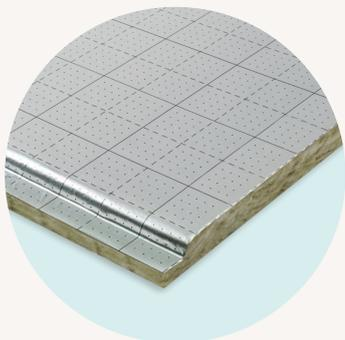
Panel de lana mineral URSA AIR para la construcción de conductos de climatización conforme a la norma UNE EN 14303, recubierto en su cara exterior por un complejo kraft-aluminio reforzado, y por su cara interior por un complejo kraft-aluminio, con sistema de marcado IN.
