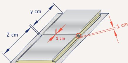
El extremo del lado de Z cm hay que mecanizar un macho y en el otro extremo hay que acabar la pared de forma recta. Será esta sección la que se encuentre en el interior de la derivación separando distribuyendo los caudales de aire.
