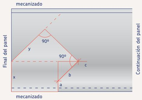
Con este último paso ya se ha dibujado la forma de la tapa curva. El siguiente paso es cortar la tapa con el cuchillo y realizar el mecanizado que le corresponda en su extremo recto tal y como se describe en el capítulo dedicado al uso de la herramienta negra.
