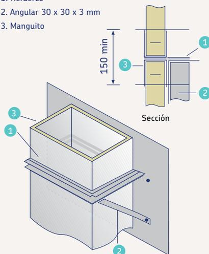
En el caso de que el conducto pase a través de un forjado se puede soportar con un perfil angular, habiendo en el interior del conducto un refuerzo de chapa galvanizada según norma UNE 100102.
