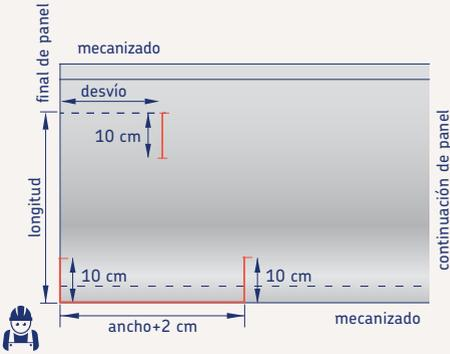
Desde la paralela del desvío hacia la derecha, marcaremos ancho de salida+2 (el ancho de salida será igual que el ancho de entrada). Después se trazará una línea paralela al ancho de salida hacia abajo a una distancia de 10 cm.
