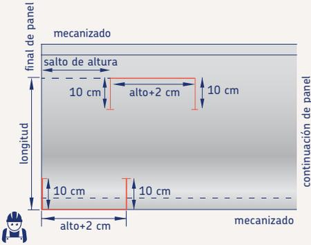
Se traza una línea paralela al mecanizado hembra a una distancia de 40 cm (de la anterior paralela marcada a 10cm) que cruce con la línea de ancho B + 2 cm. A partir de esta intersección, se traza otra línea paralela a la hembra a una distancia igual o superior a 10 cm u que se prolongará hasta el final de panel delimitando la figura que deseamos obtener.
