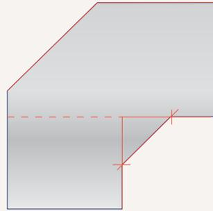
Con este último paso ya se ha dibujado la forma de la tapa de la curva. El siguiente paso es cortar la tapa con el cuchillo.
