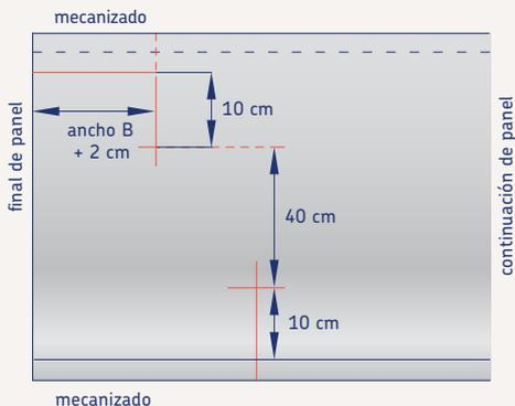
Procedemos a unir la intersección de las marcas de 10 cm con las líneas de anchos+2 entre ellas y con este último paso ya se ha dibujado la forma de la tapa de la reducción y se procede a cortarla con el cuchillo.
