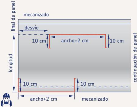
Procedemos a unir la intersección de las marcas de 10 cm. entre ellas y con este último paso ya se ha dibujado la forma de la tapa del quiebro y se procede a cortarla con el cuchillo. Las líneas diagonales deberán ser lo más suaves posibles (aprox. 20° - 25°), y nunca con una inclinación superior a 45°
