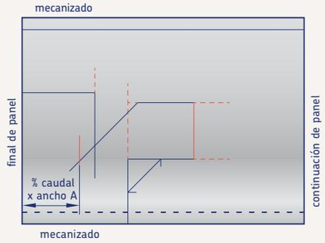
Trazar una recta paralela a una distancia igual a 1 cm de la línea superior de la diagonal del ramal y prologarla hasta que se cruce con la línea que se ha trazado anteriormente.
