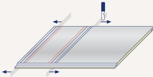
Con el cuchillo se corta la porción del panel sobrante y a continuación deben repasarse los cortes. A continuación deben repasarse los cortes efectuados por la herramienta para obtener los dos cierres longitudinales de la pared.
