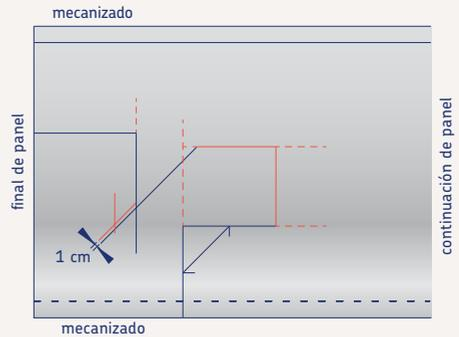
Después de cortar, la tapa resultante es la que se observa en la figura. Esta tapa tiene una ranura por la que se insertará la pared. Será la misma pared la que fuerce al caudal a ir en un sentido u otro.
