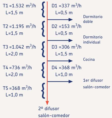
En el caso del apartamento de Alicante vamos a limitar la altura del conducto a 15 cm ya que queremos poner el falso techo con un plenum de menos de 22 cm. si completamos todos los datos del anterior esquema en la plantilla de cálculo URSA AIR, obtendremos el resultado que se observa en la siguiente imagen.
