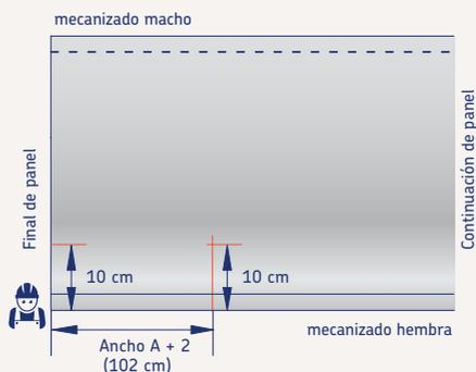
Seguidamente, realizaremos una recta paralela a final de panel a una distancia igual a la mitad del ancho de entrada A (en este ejemplo 51 cm) con la finalidad de encontrar el eje de la pieza.
