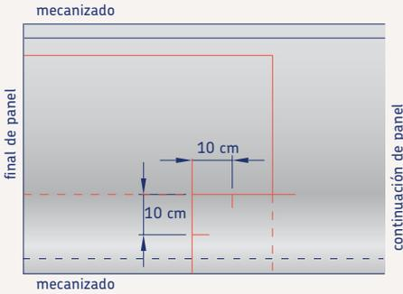
Si estas dos marcas se unen por una línea se obtiene como resultado una recta a 45°.
