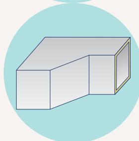
Se traza una línea paralela al mecanizado hembra a una distancia de 40 cm (de la anterior paralela marcada a 10cm) que cruce con la línea de ancho B + 2 cm. A partir de esta intersección, se traza otra línea paralela a la hembra a una distancia igual o superior a 10 cm u que se prolongará hasta el final de panel delimitando la figura que deseamos obtener.
