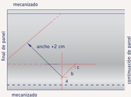
Seguidamente se traza una marca que una la esquina "b/c" con la línea "y" procurando que ésta forme un ángulo de 90° grados respecto a la línea b.
