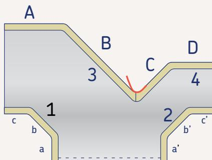
Las paredes 1 y 2 se pueden realizar como muestra la figura. Al haber 2 esquinas entrantes hay que realizar los cortes que describe el capítulo de paredes.
