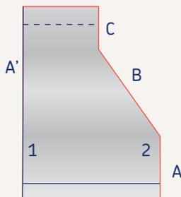
Se traslada la medida exacta del lado A y a continuación se realizará un canal de 1 cm de espesor para salvar el ángulo exterior (posteriormente se vaciará 1 cm de lana mineral que permitirá que la tabica se cierre). Seguidamente se trasladará la medida exacta del lado B y se realizará un corte recto sin dañar el revestimiento exterior. Finalmente se trasladará la longitud del lado C -0,5 cm con el fin de superar el ángulo interior.
