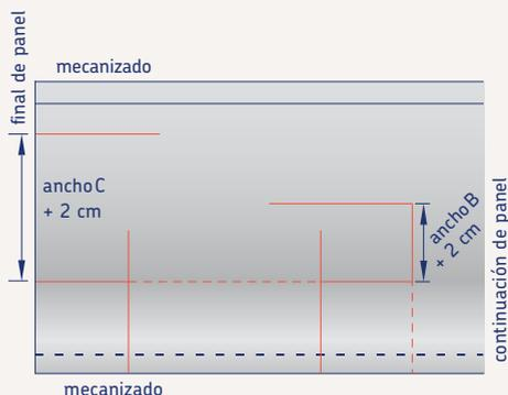
Se denominarán centros a las intersecciones de las líneas que definen el conducto de entrada con las líneas que definen los conductos de salida.
