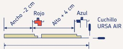
Finalmente, procederemos a separar nuestra pieza del resto del panel con el cuchillo. Para la obtención de la segunda pieza (L), deberemos repetir los mismos pasos realizados para la obtención de la primera pieza.
