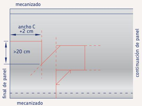
Con este último paso ya se ha dibujado la forma de la tapa de la derivación. El siguiente paso es cortar la tapa con el cuchillo.
