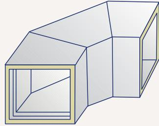
El método de tapas y tabicas permite realizar figuras con cambios de dirección curvos o rectos tal y como muestra la siguiente ilustración.
