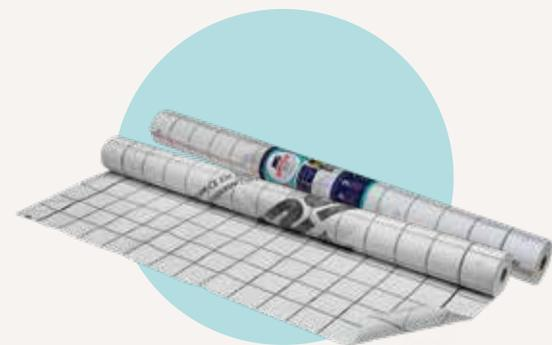
Membrana barrera de vapor con estanqueidad al aire, de polietileno, de 0,3 mm de espesor y 100 g/m<sup>2</sup>, de Sd fija de 25 m espesor de aire equivalente frente a la difusión de vapor de agua, según UNE EN 1931, permeabilidad al aire 0,014 m<sup>3</sup>/h·m<sup>2</sup> a 50 Pa, (Euroclase E de reacción al fuego según UNE EN 13501-1), rango de temperatura de trabajo de -40 a 80°C, suministrada en rollos de 1,50x25 m, según UNE EN 13984.
