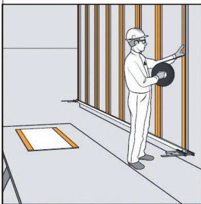
Figura 218. Aplicación de la cinta.
