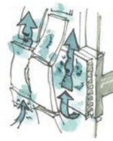
F. Deformación de componentes fachada
