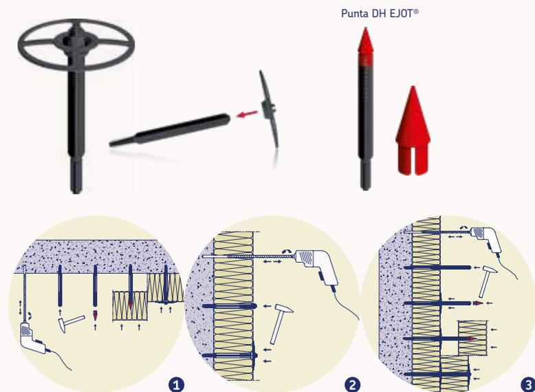
Fijación para la sujeción del aislamiento en fachada ventilada sobre mampostería y hormigón. Se puede montar el vástago previamente al panel (imagen 1) o de forma tradicional atravesando el panel (imagen 2). También, permite la instalación de una o varias capas de aislamiento con el mismo anclaje (imagen 3).
