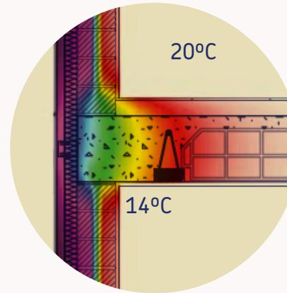
En el gráfico se ha realizado la simulación de una termografía, y se puede observar la pérdida de confort térmico que tenemos en el frente de forjado.
