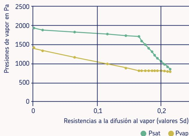
NOTA: Es desaconsejable la colocación de capas externas al aislante (por ejemplo films de plástico) que pudiesen ser impermeables al vapor de agua. En ningún caso los recubrimientos de los paneles aislantes funcionan como barrera al paso del vapor de agua, y no precisan de ninguna protección frente al agua.
