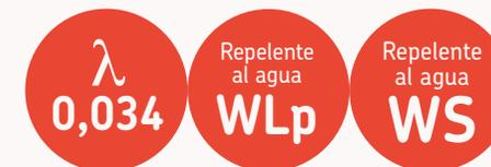
Panel semirrígido de lana mineral URSA TERRA conforme a la norma UNE EN 13162, no hidrófila, recubierto por la cara exterior con un tejido Zero de alta resistencia. Suministrado en panel y panel enrollado.
