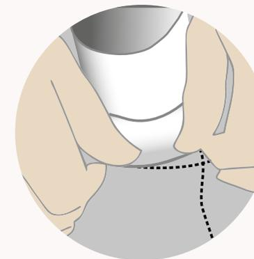
5. Después de haber retirado la segunda protección desechable, **plegar y enrollar la brida PassFlex** a la membrana de manera sistemática gracias a la elasticidad del PassFlex.
