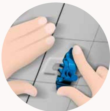
5. **Enganchar** el cabezal de fijación azul en el orificio de la suspensión insertando un borde, a continuación girar el cabezal hacia el otro borde.
