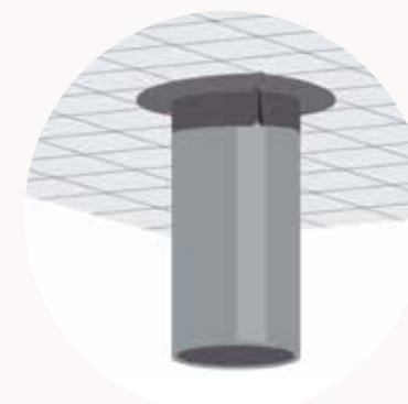
5. **Para formar bien el PassFlex**, estirar y encolar este acoplamiento a medida en contacto con la membrana.
