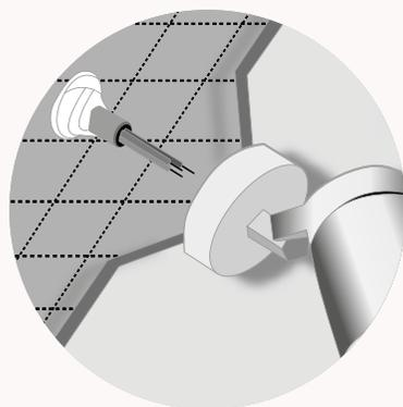
2. **Cortar ligeramente la membrana**, colocar el conducto adicional y selle a continuación la abertura con el adhesivo universal **URSA SECO®**.
