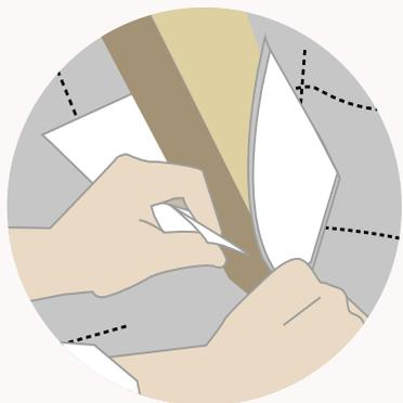
1. **Desenrollar el PassFlex** alrededor del elemento que se desea **sellar** sobresaliendo unos 10 mm en todo el perímetro de la pieza de la estructura.
