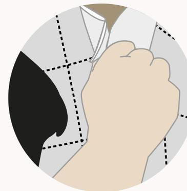
4. **Pegar y cerrar el solape** creado alrededor de la pieza de la estructura colocando adhesivo sobre adhesivo: la fusión en frío se efectúa inmediatamente para una estanqueidad perfecta del acoplamiento.
