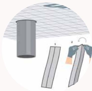
1. **Desenrolle el PassFlex** alrededor del elemento que se desea sellar sobresaliendo unos 10 mm en todo el perímetro del conducto y de la tubería.
