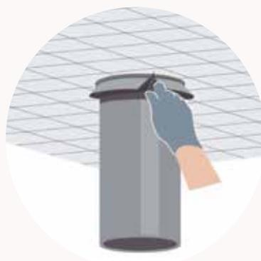
3. **Retirar una de las dos tiras de protección** para aplicar, sin estirar, el PassFlex aún doblado alrededor del elemento pasante. **Encole el PassFlex** y cierre el acoplamiento creado alrededor de la tubería o del conducto colocando adhesivo sobre adhesivo: la fusión en frío se efectúa inmediatamente sobre los 10 mm que sobrepasan.
