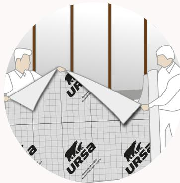
1. **Desenrollar la membrana** colocando su cara rugosa no impresa directamente sobre la estructura de madera.
