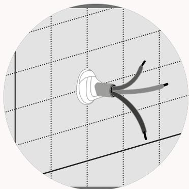
En lo que respecta al paso de instalaciones, se usa la cinta adhesiva **URSA SECO®**: se coloca alrededor de cada macarrón y permite efectuar un empalme del conducto-membrana perfectamente estanco.
