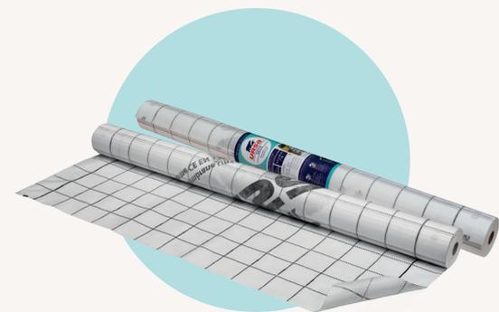
Membrana barrera de vapor con estanqueidad al aire, de polipropileno, de 0,3 mm de espesor y 100 g/m<sup>2</sup>, de Sd fija de 25 m espesor de aire equivalente frente a la difusión de vapor de agua, según UNE EN 1931, permeabilidad al aire 0,02 m<sup>3</sup>/h·m<sup>2</sup> a 50 Pa, (Euroclase E de reacción al fuego según UNE EN 13501-1), rango de temperatura de trabajo de -40 a 80°C, suministrada en rollos de 1,50x25 m, según UNE EN 13984.
