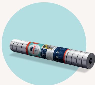
Membrana barrera de vapor translúcida reforzada flexible en 100% Poliolefina de color: Gris de valor Sd variable de 15 cm a 5 m. Con una resistencia mecánica excepcional, es adecuado para todas las situaciones y condiciones del sitio. Suministrada en rollos de 1,50x50 m, según UNE EN 13984.
