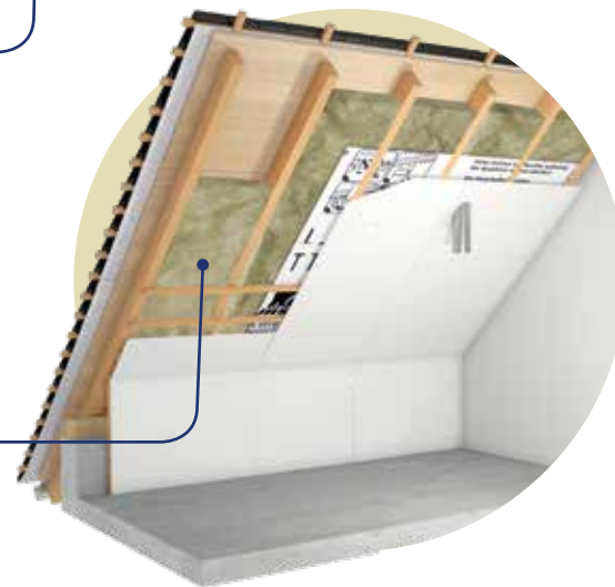
1. Teja cerámica 2. Solera de ladrillo machihembrado 3. Tabiquillo cerámico formación de pendientes con mortero 4. URSA TERRA Manta Papel 5. Forjado
