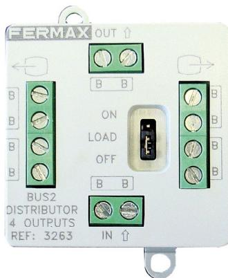
El distribuidor BUS-2 es un dispositivo que se encarga de encaminar el bus desde la placa hasta el monitor/teléfono activo, manteniendo la alimentación y la señal de datos sobre todos los monitores/teléfonos en todo momento. Sólo para instalaciones con monitores B/N. El distribuidor abre el camino hacia el monitor/teléfono activo y cierra el paso de las señales de video y audio en el resto de los ramales.
