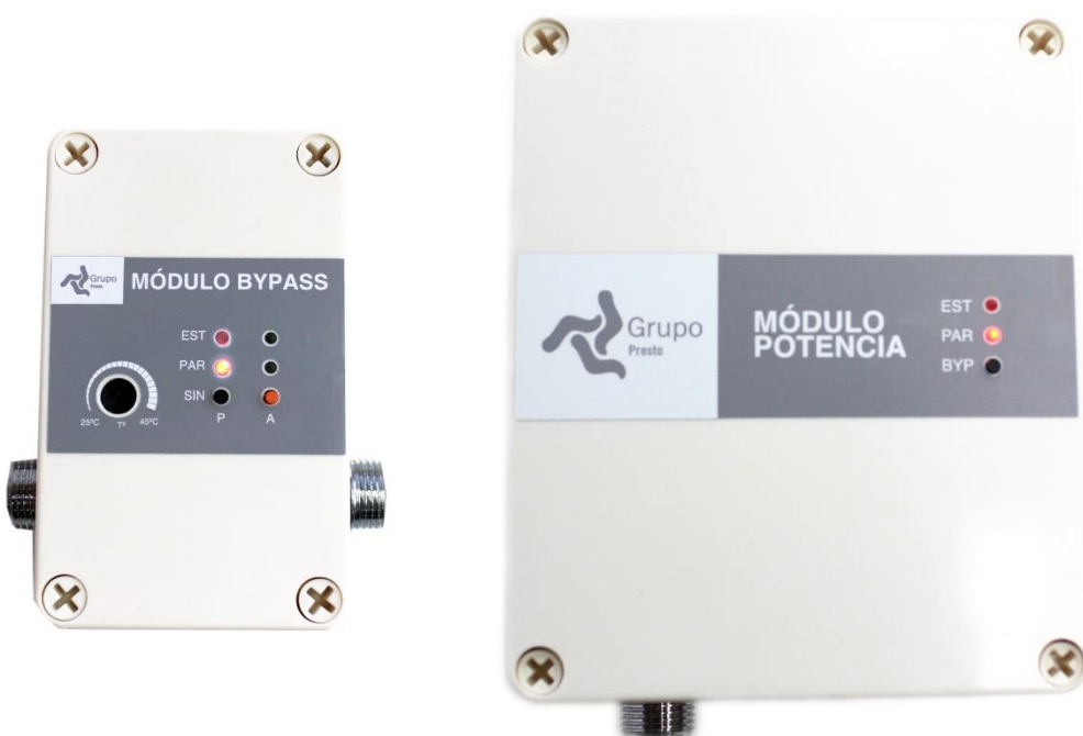
Figura 53. Emparejamiento fallido: LED PAR.P y PAR color rojo durante 30 segundos en los módulos de bypass (2) y potencia (1 o 4).
