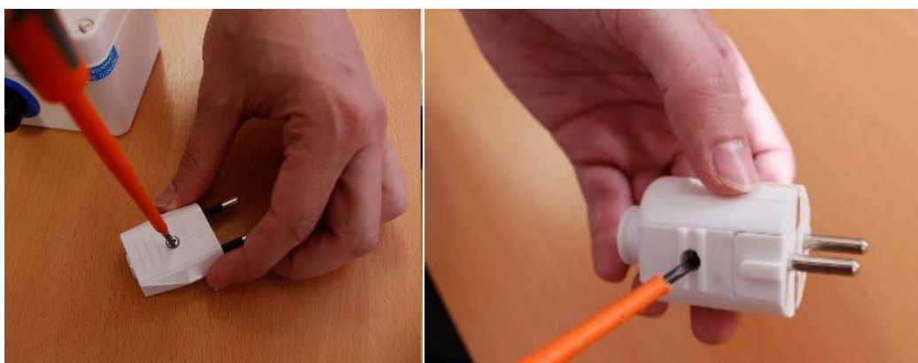
Figura 42. Desmontado del terminal tipo C y F (Schuko).
