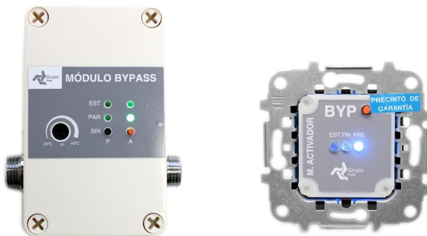
Figura 56. Emparejamiento correcto: LED PAR.A color verde en el módulo de bypass (2) y LED EST color azul en el módulo de activación (3), ambos durante 30 segundos.
