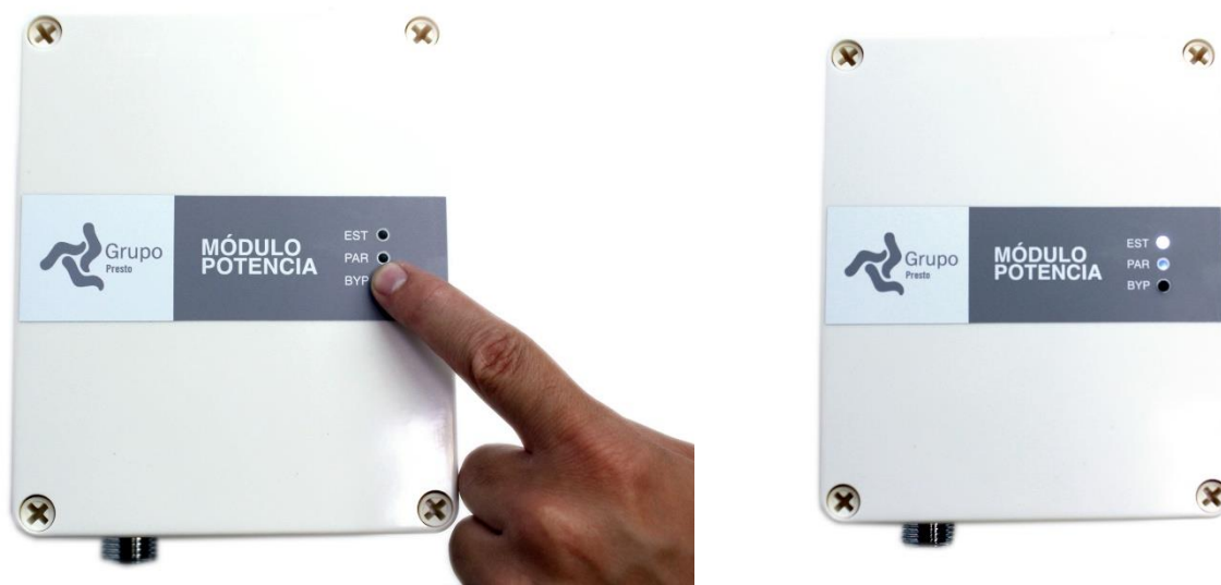
Figura 51. Botón negro (BYP) del módulo de potencia (1 o 4) presionado hasta que LED EST esté en blanco parpadeante.
