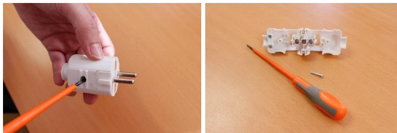
Figura 104. Desmontado del terminal tipo Schuko.
