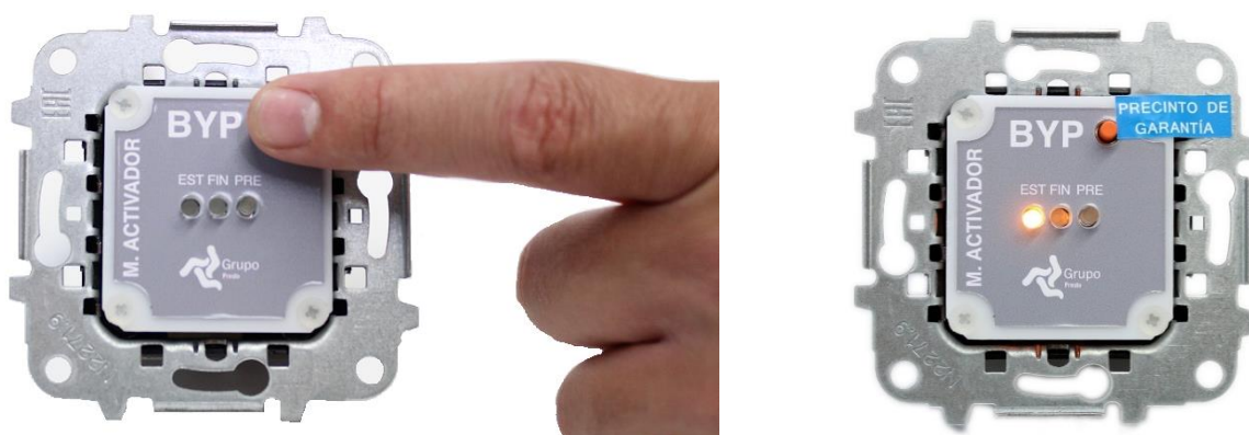
Figura 54. Botón naranja del módulo de activación (3) presionado hasta que LED EST esté en amarillo parpadeante.
