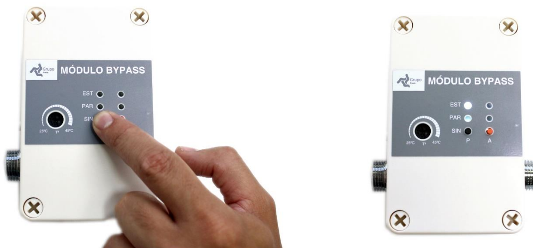
Figura 50. Botón negro (P) del módulo de bypass (2) presionado hasta que LED EST.P esté en blanco parpadeante.
