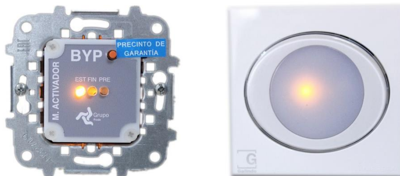
Figura 24. Activador (3) con LED EST en Amarillo Parpadeante. El agua no ha alcanzado la temperatura de consigna seleccionada una vez ha concluido el ciclo.
