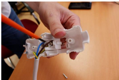
Figura 105. Conexión de los cables a los terminales de la toma Schuko.
