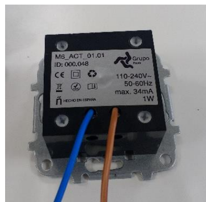
Figura 1112. Cables de alimentación conectados a clemas del módulo de activación.
