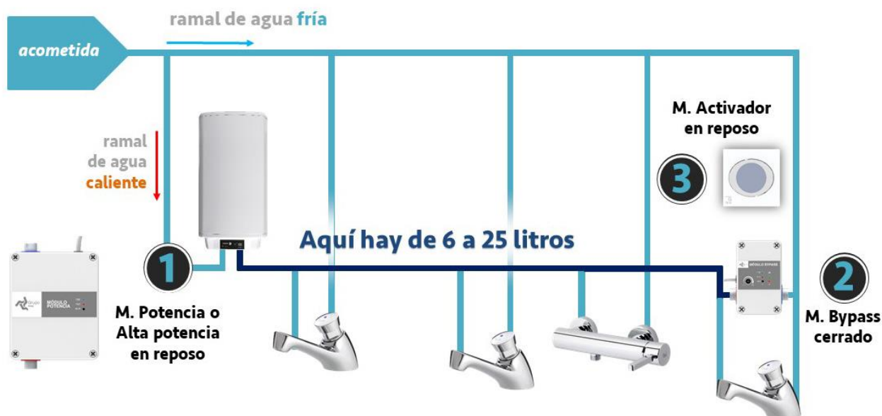
Figura 2. Esquema simplificado de la instalación de la TECNOLOGÍA NESS
