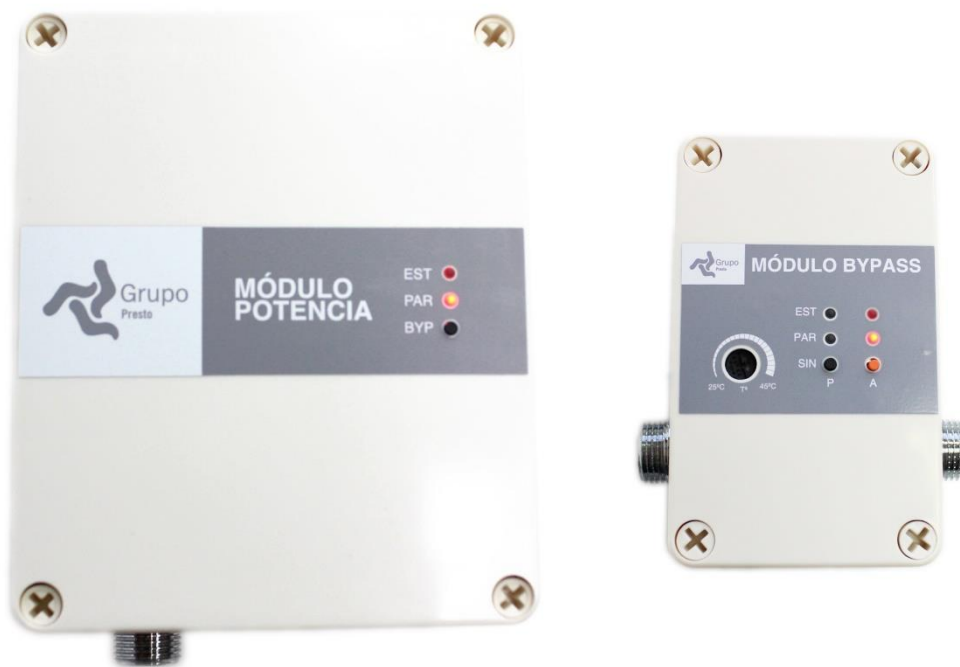
Figura 26. Módulo de Bypass (2) y Módulo de potencia (1 o 4) con LED PAR.P y LED PAR en Rojo Fijo. Comunicación entre módulos de bypass (2) y de potencia (1 o 4) no efectiva.
