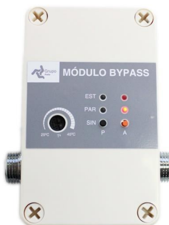
Figura 25. Módulo de Bypass (2) con LED PAR.A en Rojo Fijo: Comunicación entre módulos de activación (3) y de Bypass (2) no efectiva.
