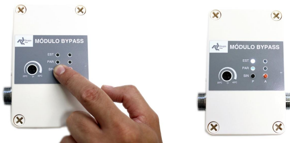
Figura 55. Botón naranja (A) del módulo de bypass (2) presionado hasta que LED EST.A esté en blanco parpadeante.
