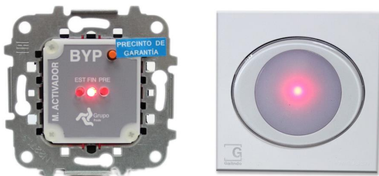
Figura 23. Activador (3) con LED FIN en ROJO Fijo: El agua ha alcanzado la temperatura de consigna seleccionada.
