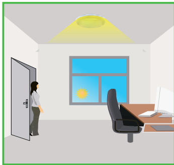
Cuando la luz natural es suficiente o está oscura, se detecta movimiento y la luz se enciende al 100 % de brillo.
