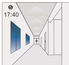
La luz se enciende automáticamente al 10% cuando la luz natural es insuficiente (sin movimiento).
