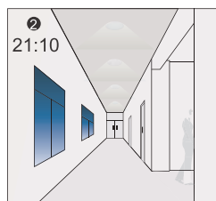
La luz se atenúa hasta el nivel de espera después del tiempo de espera.
