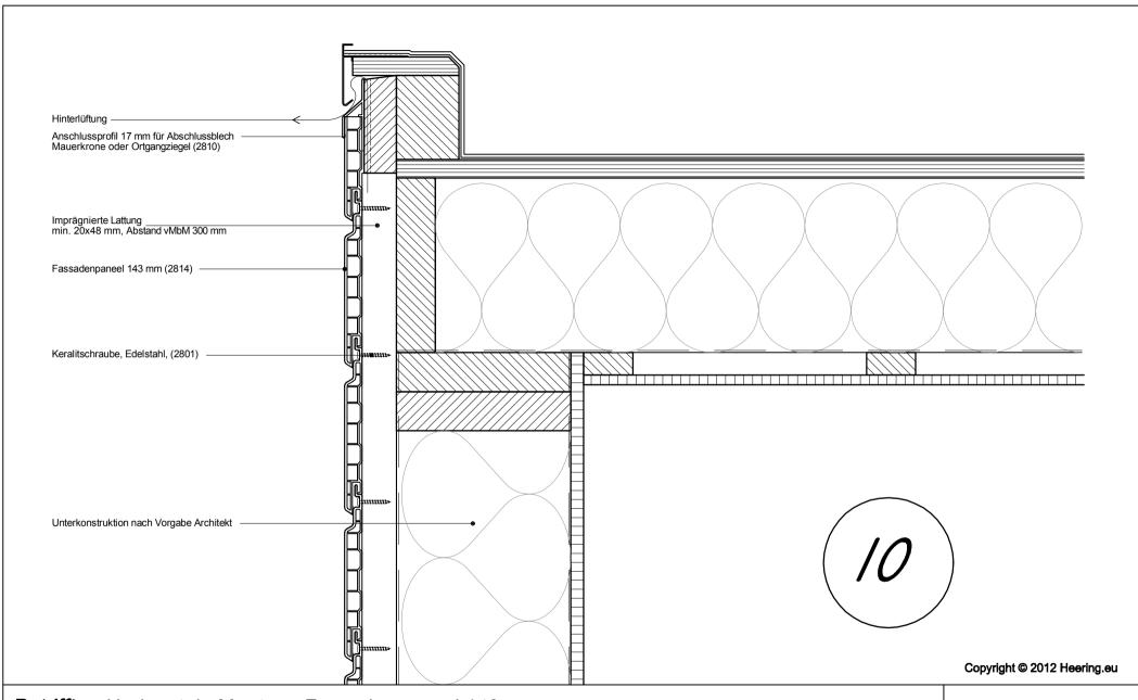
**Betrifft:** Horizontale Montage Fassadenpaneel 143 mm Anschluss unter Abschlussblech auf Mauerkrone
