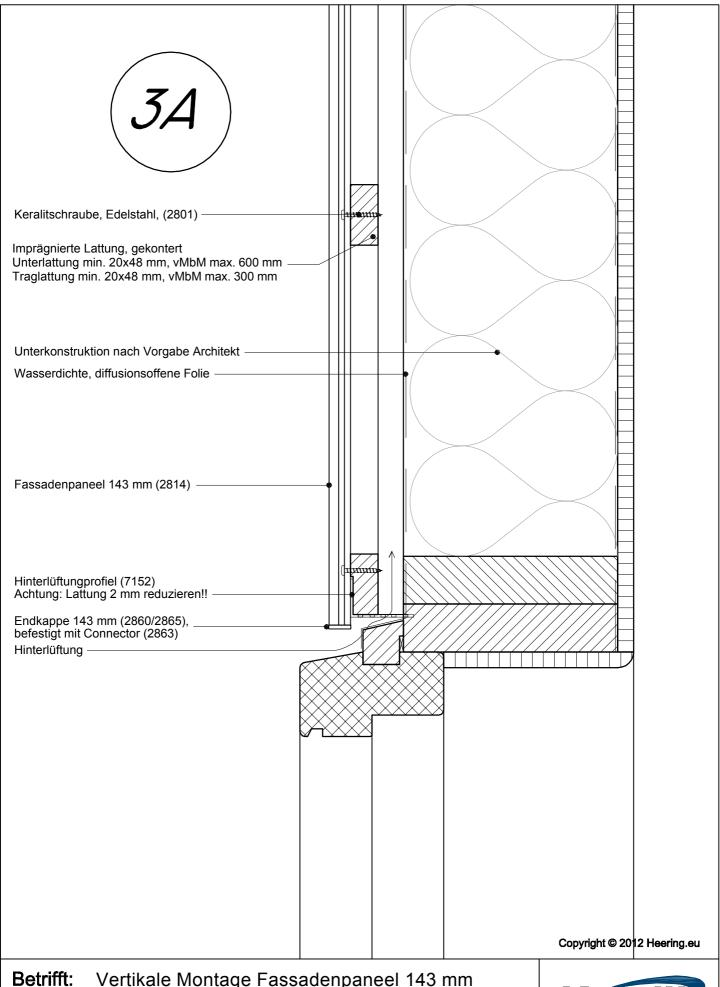
Vertikale Montage Fassadenpaneel 143 mmÜber dem Fenster mit Endkappe 2860/2865
