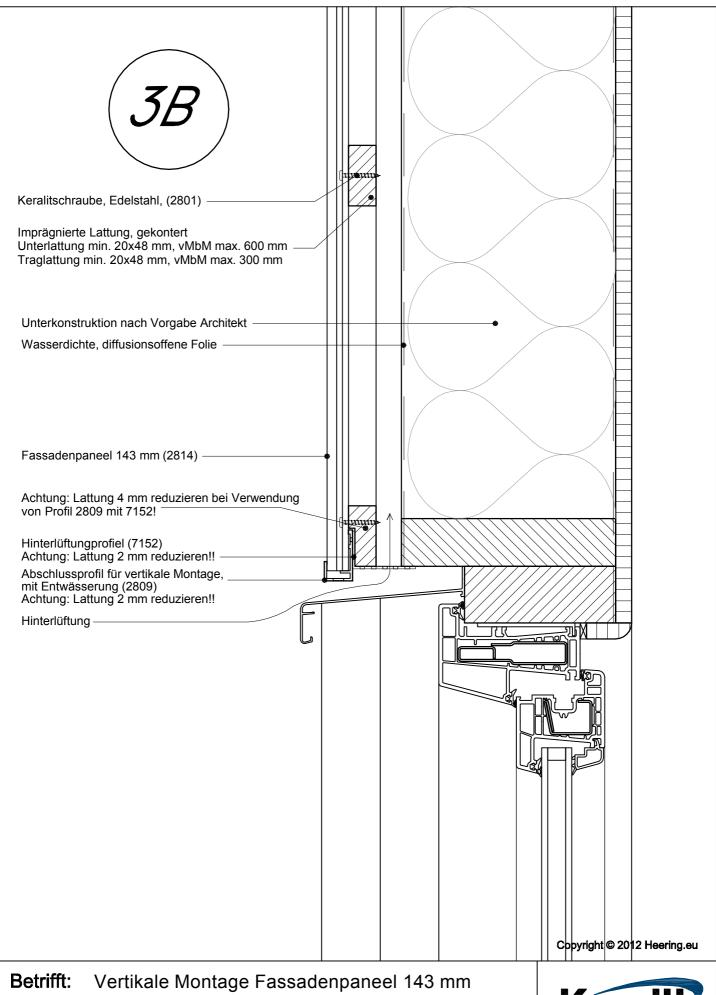
Vertikale Montage Fassadenpaneel 143 mm Über dem Fenster mit Umrandungsprofil 2809
