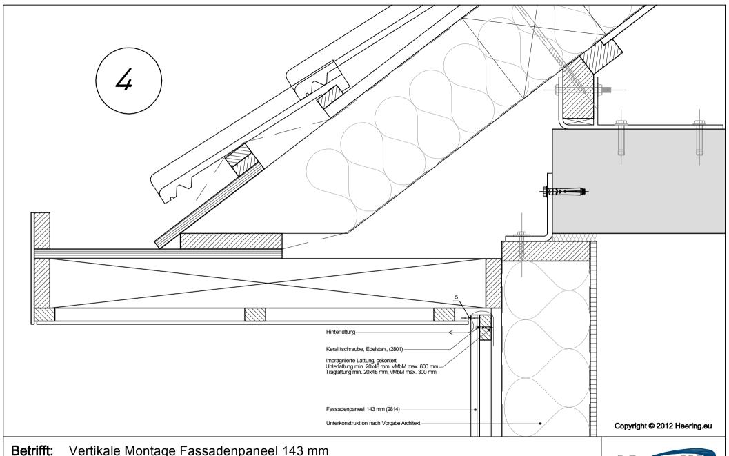
**Betrifft:** Vertikale Montage Fassadenpaneel 143 mm Anschluss Kastenrinne
