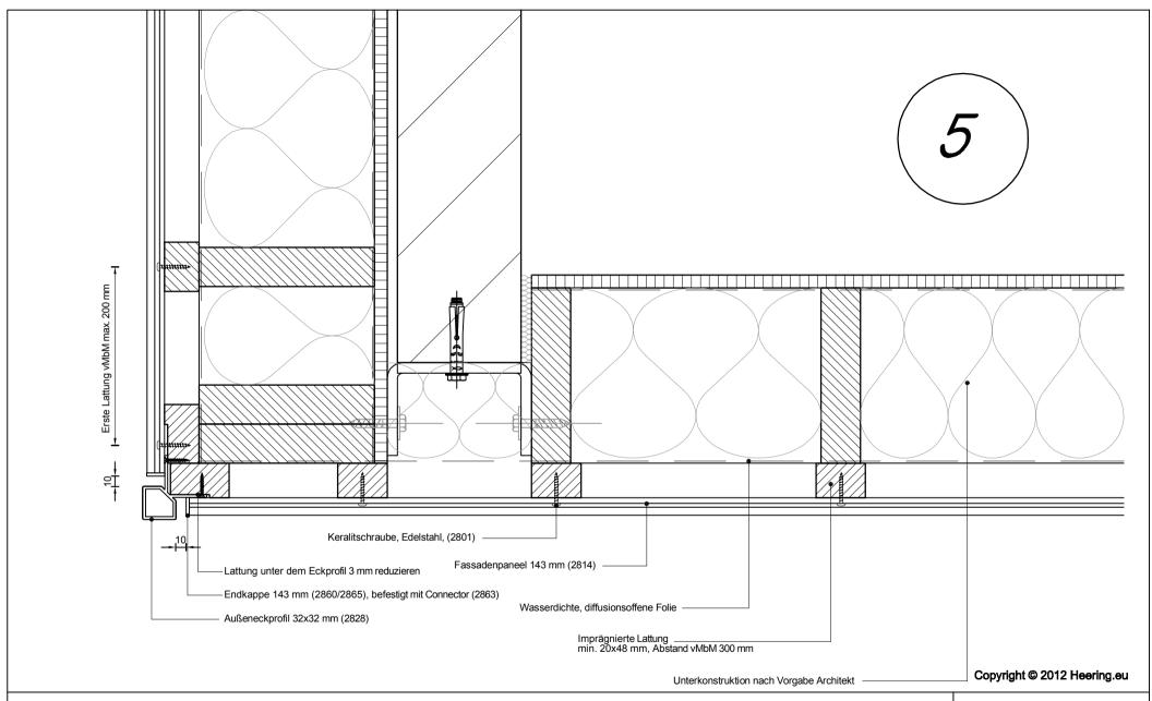
Betrifft: Horizontale Montage Fassadenpaneel 143 mm Außeneck gestaltung mittels Eckprofil 2828
