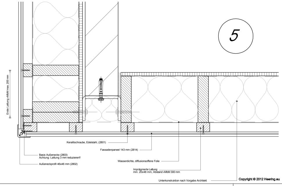
Betrifft: Horizontale Montage Fassadenpaneel 143 mm Außeneck gestaltung mittels Eckprofil 2802
