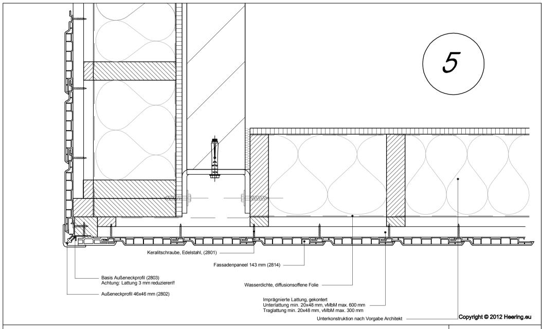
Betrifft: Vertikale Montage Fassadenpaneel 143 mm Außeneckgestaltung mittels Eckprofil 2802
