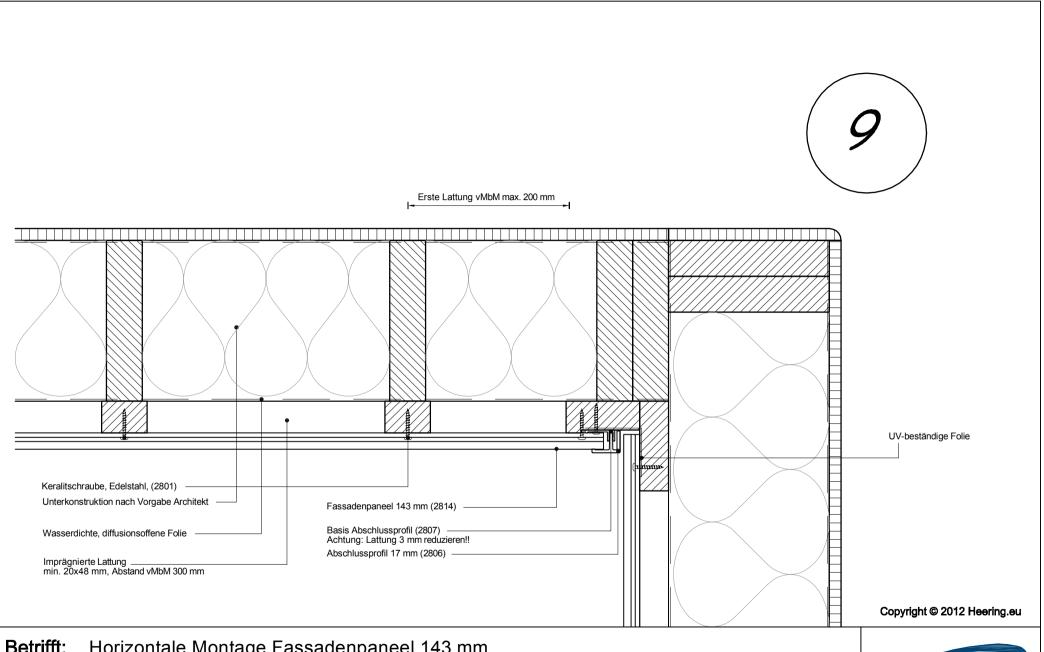
**Betrifft:** Horizontale Montage Fassadenpaneel 143 mm Inneneckgestaltung mittels Abschlussprofil 2806
