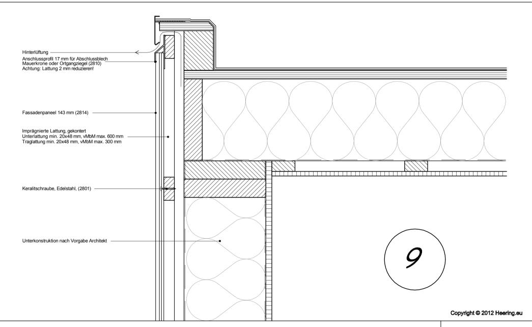
**Betrifft:** Vertikale Montage Fassadenpaneel 143 mm
