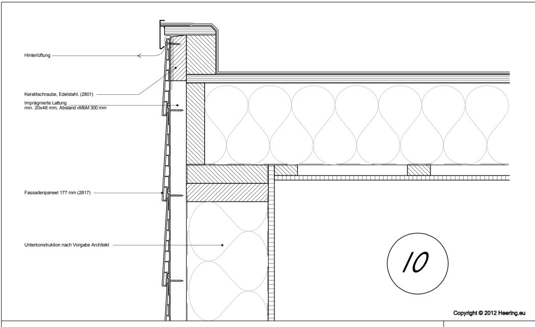
**Betrifft:** Horizontale Montage Fassadenpaneel 177 mm Anschluss unter Abschlussblech auf Mauerkrone
