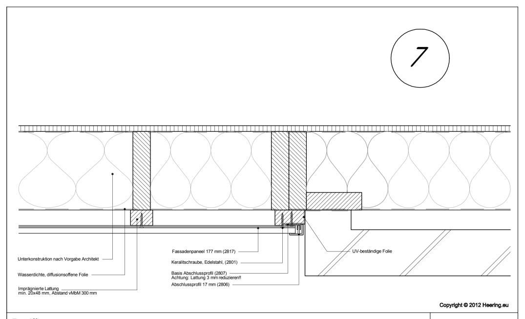
**Betrifft:** Horizontale Montage Fassadenpaneel 177 mm Stoß gegen Mauerwerk
