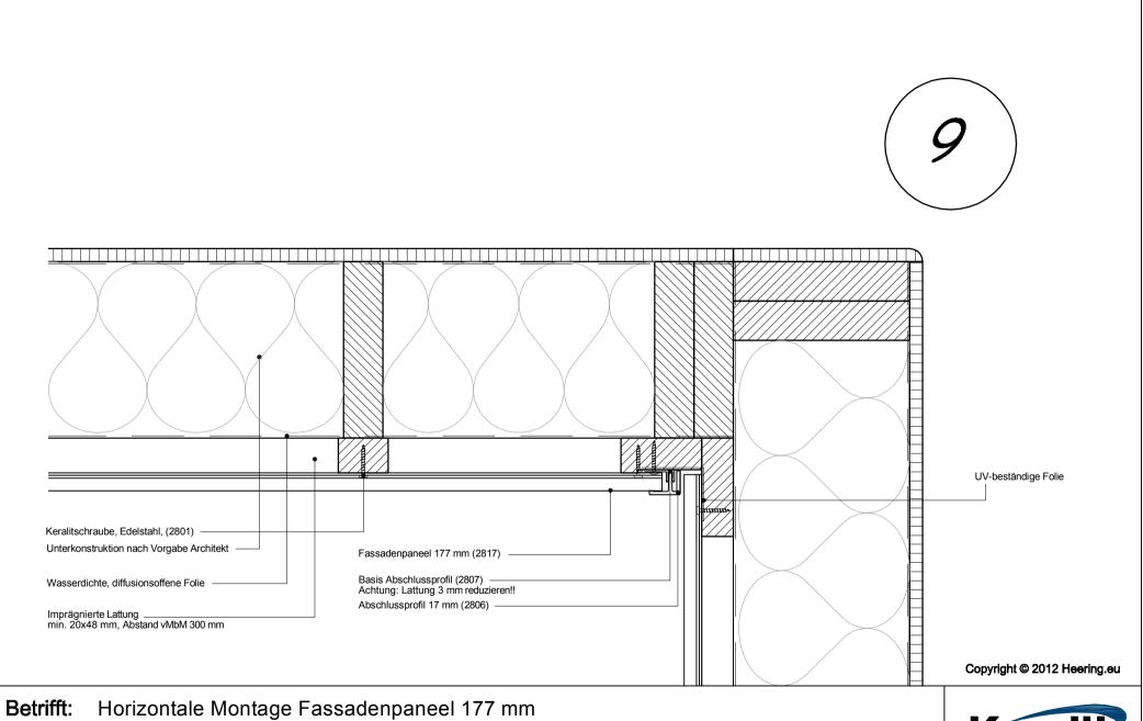
Inneneckgestaltung mittels Abschlussprofil 2806
