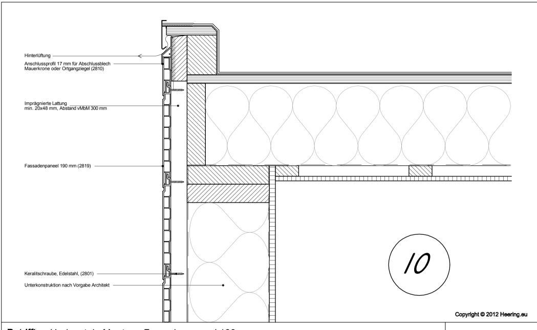
**Betrifft:** Horizontale Montage Fassadenpaneel 190 mm Anschluss unter Abschlussblech auf Mauerkrone
