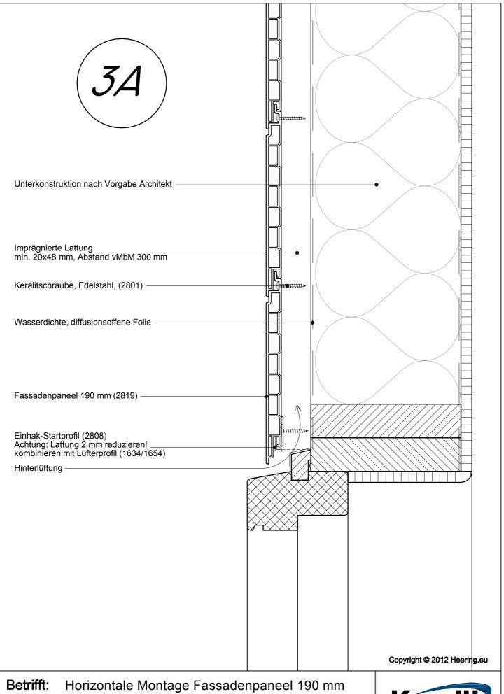
**Betrifft:** Horizontale Montage Fassadenpaneel 190 mm Über dem Fenster
