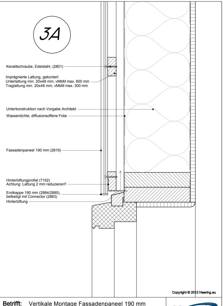
ifft: Vertikale Montage Fassadenpaneel 190 mm Über dem Fenster mit Endkappe 2884/2885
