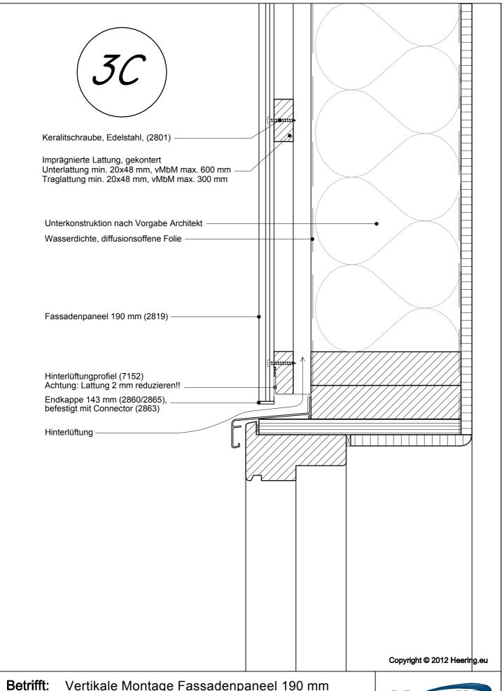
etrifft: Vertikale Montage Fassadenpaneel 190 mm Über dem Fenster mit Endkappe 2884/2885
