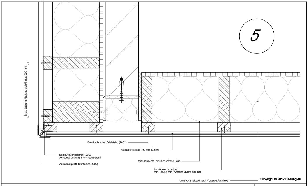
**Betrifft:** Horizontale Montage Fassadenpaneel 190 mm Außeneckgestaltung mittels Eckprofil 2802
