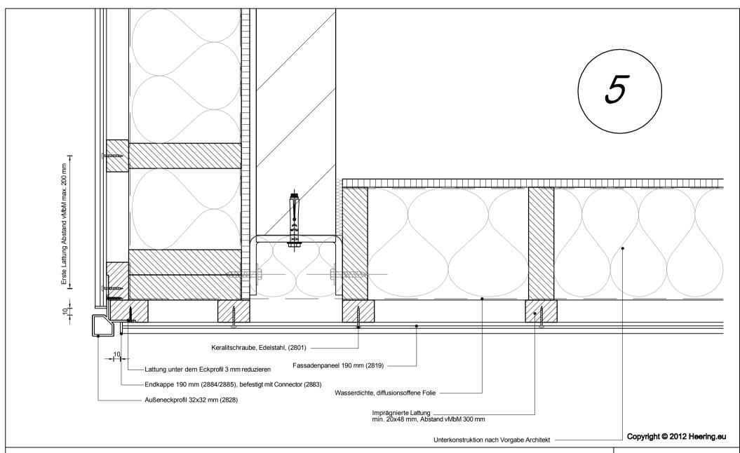
Betrifft: Horizontale Montage Fassadenpaneel 190 mm Außeneckgestaltung mittels Eckprofil 2828
