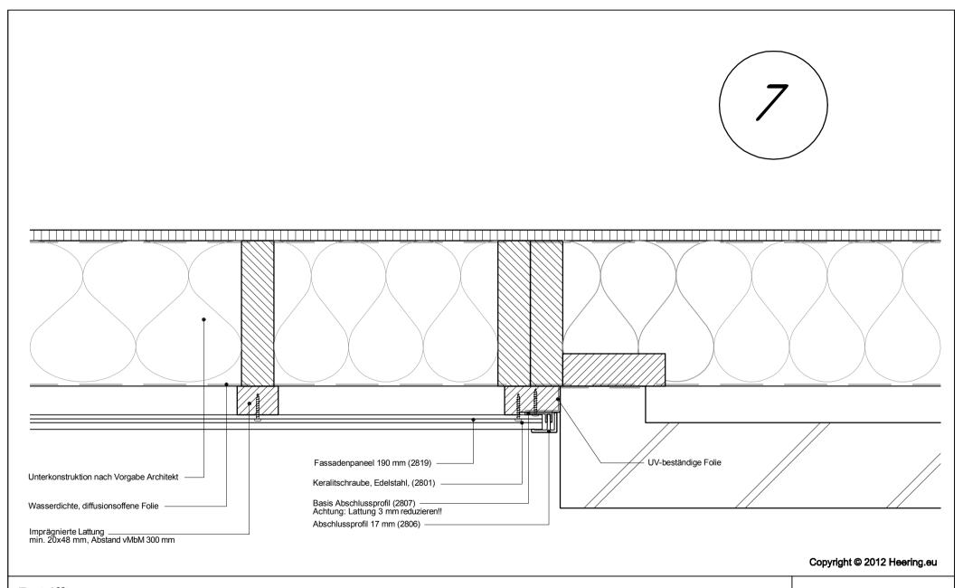
**Betrifft:** Horizontale Montage Fassadenpaneel 190 mm Stoß gegen Mauerwerk
