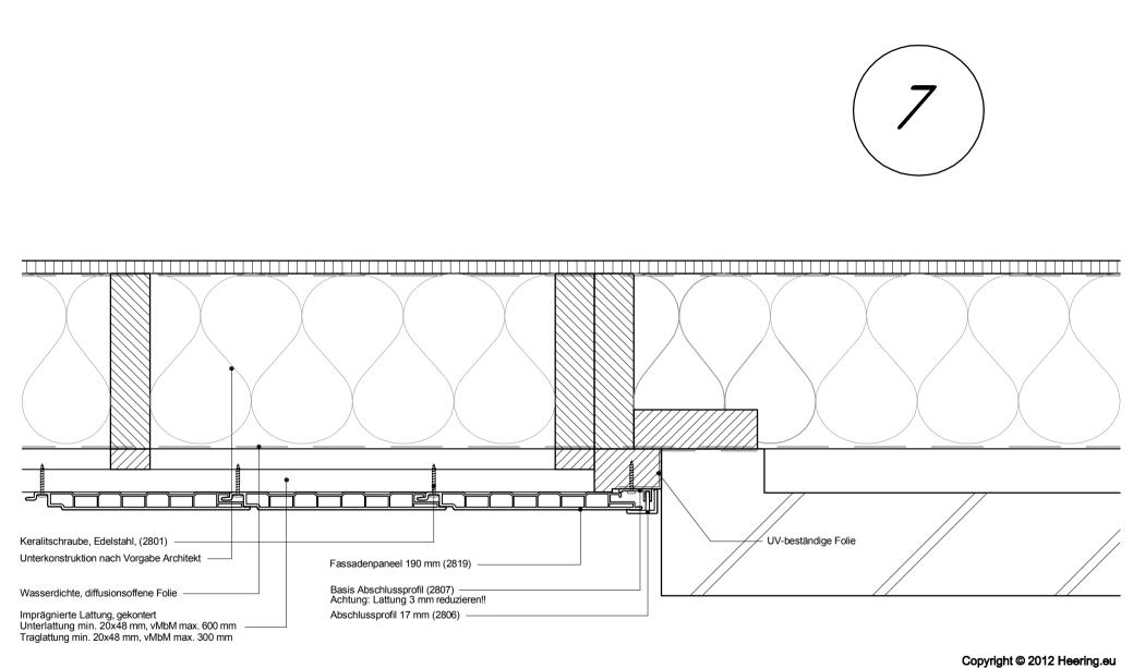
Vertikale Montage Fassadenpaneel 190 mm Betrifft: Stoß gegen Mauerwerk
