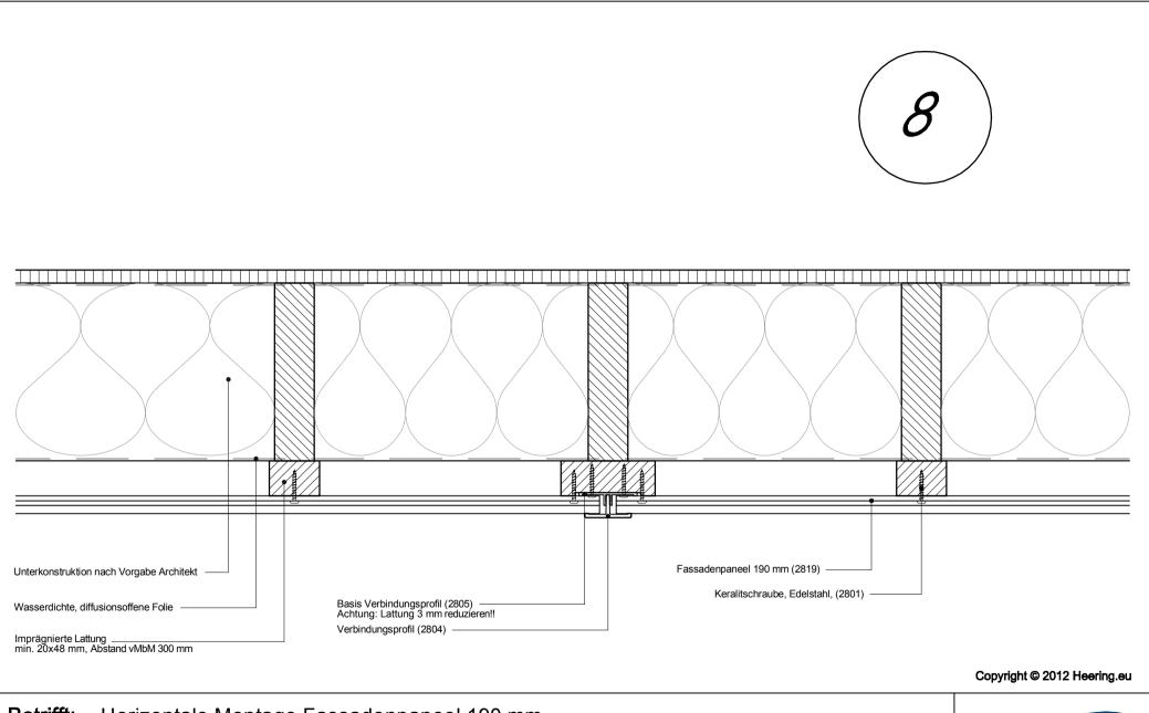
**Betrifft:** Horizontale Montage Fassadenpaneel 190 mm Verlängerung mittels Verbindungsprofil 2804
