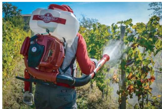
**El pulverizador L3EDA**, es una nueva evolución de la famosa L3, una máquina destinada a los profesionales que garantiza una larga duración y capacidad de trabajo. Es una máquina para uso profesional, pero, al mismo tiempo, muy simple de usar, pues solo hay que regular el acelerador y el grifo. El pulverizador cuenta con un carburador de bandeja descubierta y los pernos con cabeza unificada: es suficiente una llave para desmontar toda la máquina.
