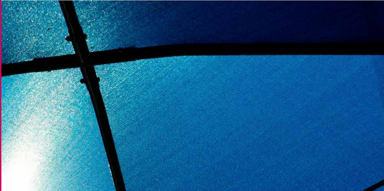
La malla Raschel es una tela tejida con rafia de polietileno de alta densidad. Su tejido de punto por urdimbre evita su desarme cuando se cortan las cintas, asegurando mayor resistencia, durabilidad y una obtención de sombra uniforme sobre el área cubierta.
