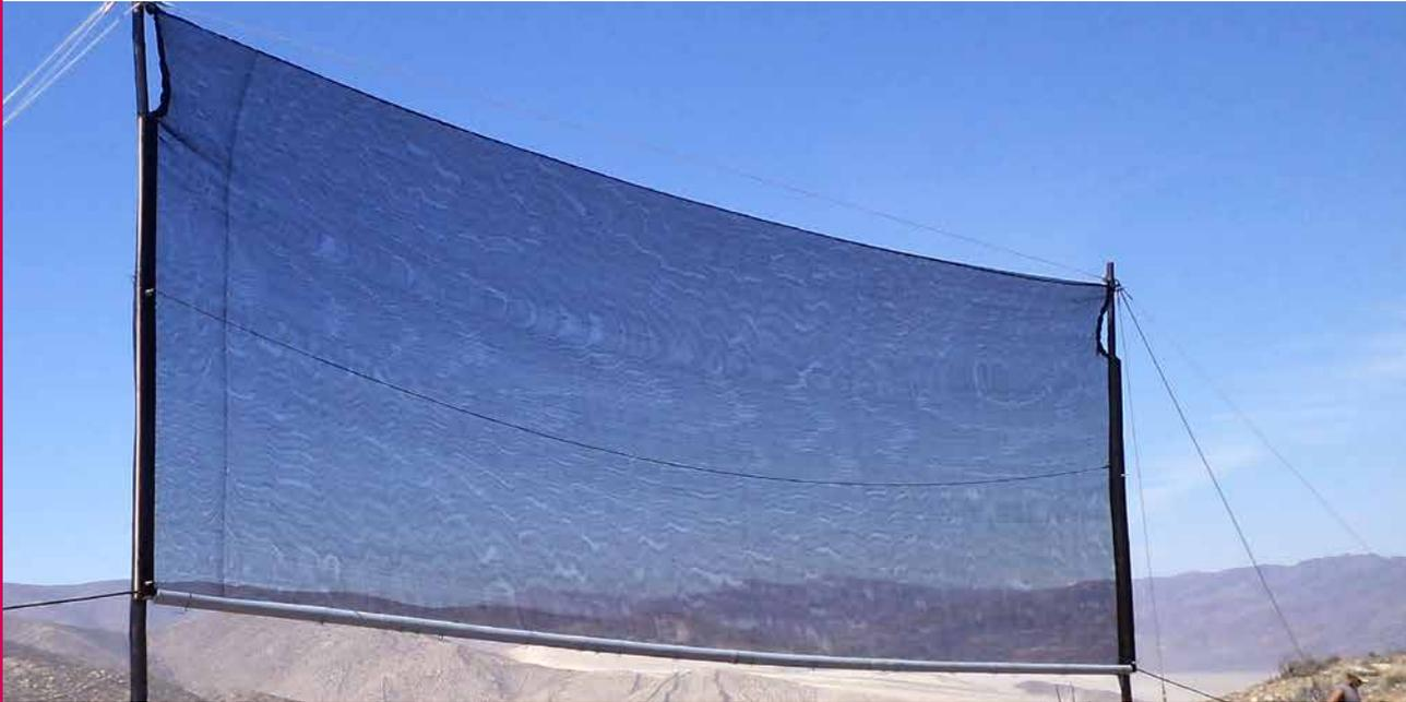
La malla Raschel es una tela tejida con rafias de polietileno de alta densidad. Su tejido de punto por urdimbre evita su desarme cuando se cortan las cintas, asegurando mayor resistencia, durabilidad y una obtención de sombra uniforme sobre el área cubierta.
