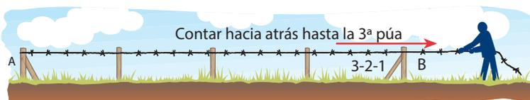
Tire el alambre con una palanca de manera que la púa (en este caso la tercera) quede frente a la estaca B; amarre al poste principal final con dos vueltas al poste y nudo embarrilado. Asegure con grapas.
