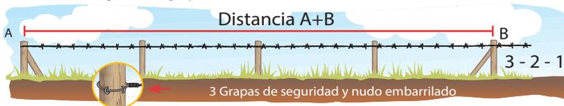
4 Finalmente, engrape la hebra a las estacas intermedias, es importante no aplastar el alambre con la grapa que sirve de pasador, ya que dañará el recubrimiento de zinc.
