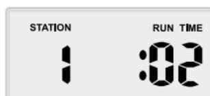
Utilice esta característica para comprobar si las válvulas y los aspersores funcionan correctamente. La unidad activará todas las estaciones consecutivamente. El tiempo preajustado en fábrica de 2 minutos por estación es ajustable. El nuevo tiempo de trabajo ajustado se convertirá en el nuevo tiempo predeterminado
