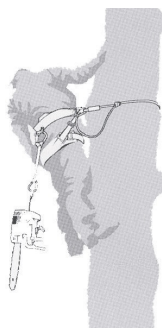
Enganche de la motosierra para poda de árboles al punto central trasero del arnés.
