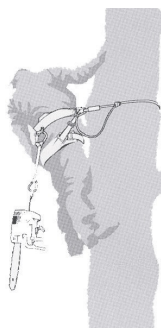
Fixez la tronçonneuse d'élagage au point central arrière du harnais.
