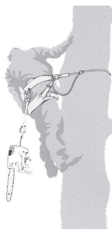
Fissare la motosega per potatura alberi al punto centrale posteriore dell'imbracatura.
