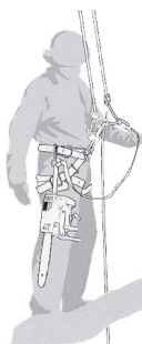
Enganche de la motosierra para poda de árboles al arnés del operador.
