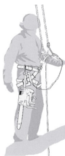
Fissaggio della motosega per potatura alberi all'imbracatura dell'operatore.
