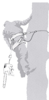
Prenda a motosserra para poda de árvores no ponto central traseiro do chicote.
