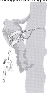
Befestigen Sie die Baumschnitt-Kettensäge am hinteren Mittelpunkt des Tragegurts.
