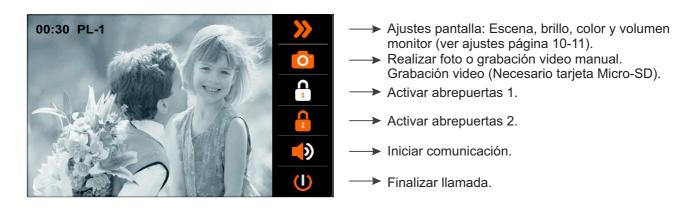
G si se desea abrir la puerta, presionar el pulsador abrepuertas durante el proceso de llamada: una sola pulsación activa el abrepuertas durante 5 segundos.
