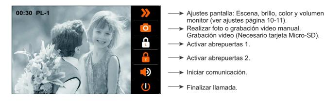
G Si se desea abrir la puerta, presionar el pulsador abrepuertas durante el proceso de llamada: una sola pulsación activa el abrepuertas durante 5 segundos.
