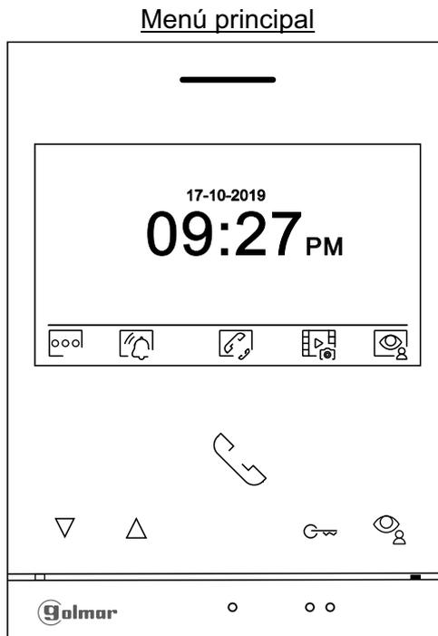
Si el equipo se encuentra en reposo (pantalla apagada), para acceder al menú principal presione en cualquiera de los pulsadores del monitor. A continuación presione sobre el pulsador situado justo debajo del icono correspondiente. El equipo volverá al estado de reposo transcurrido 10 segundos sin actividad.
