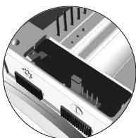
Dans le cas d'installations avec câble coaxial, le pontet de fin de ligne est placé sur le connecteur CN4 (CN2 dans le cas du moniteur Platea/Tekna Uno), situé sur la partie arrière du moniteur.
