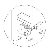
Insérez la tige charnière, fournie avec le produit, dans le boîtier d'encastrement, comme l'illustre le schéma.
