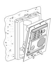
Le bâti peut maintenant être rabattu horizontalement afin de faciliter les travaux de branchement et les réglages du groupe phonique.
