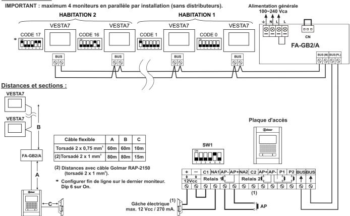
(1) Important : en ce qui concerne les gâches électriques de courant alternatif ou une 2° gâche électrique, se reportez au schéma « connexion de gâche électrique de courant continu et alternatif », page 19.
