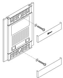
Fixer la plaque de rue au boîtier d'encastrement au moyen des vis fournies.
