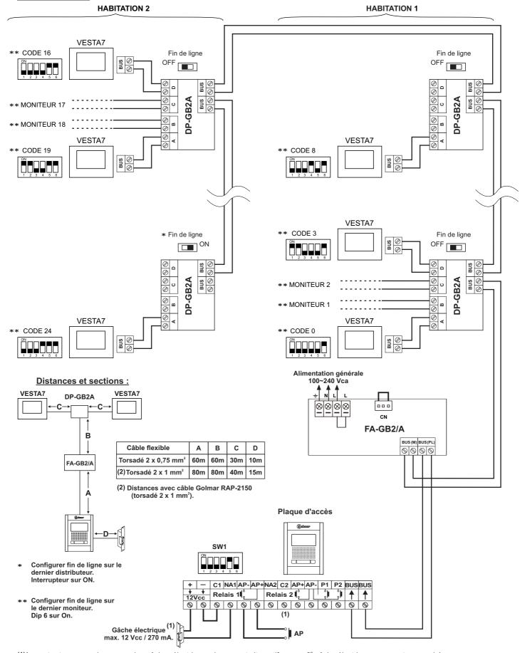
(1) Important : en ce qui concerne les gâches électriques de courant alternatif ou une 2° gâche électrique, se reportez au schéma « connexion de gâche électrique de courant continu et alternatif », page 19.
