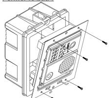
Une fois les travaux de câblage, de configuration et de réglages terminés, fixez le bâti dans le boîtier d'encastrement au moyen des vis fournies.
