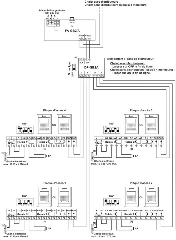
(1) Important : en ce qui concerne les gâches électriques de courant alternatif ou une 2° gâche électrique, se reportez au schéma « connexion de gâche électrique de courant continu et alternatif », page 19.
