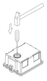
Percez la cloison du boîtier <u>dans sa partie inférieure pour</u> <u>le passage des câbles</u>.
