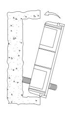
Passez les câbles à travers le boîtier d'encastrement. Encastrez, arasez et mettez à niveau le boîtier. Une fois le boîtier installé, ôtez les protections adhésives des orifices de fixation.
