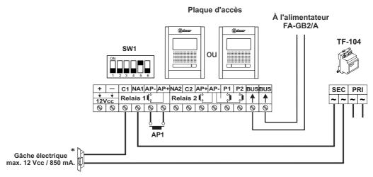
\* Important : installez la varistance fournie avec le kit directement sur les bornes de la gâche électrique.
