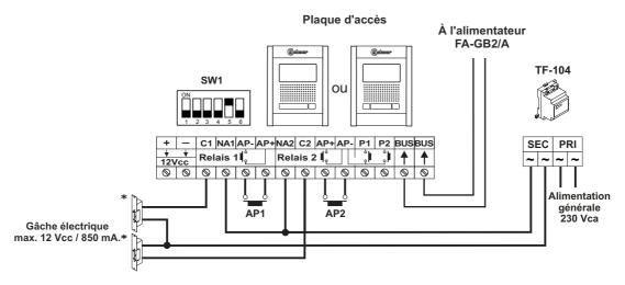
\* Important : installez les varistances fournies avec le kit directement sur les bornes de chacune des 2 gâches électriques..
