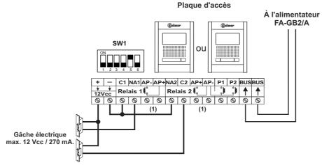
(1) Important: avec 2 gâches électriques de courant continue, il est impossible d'utiliser les poussoirs d'ouverture de porte « AP ».
