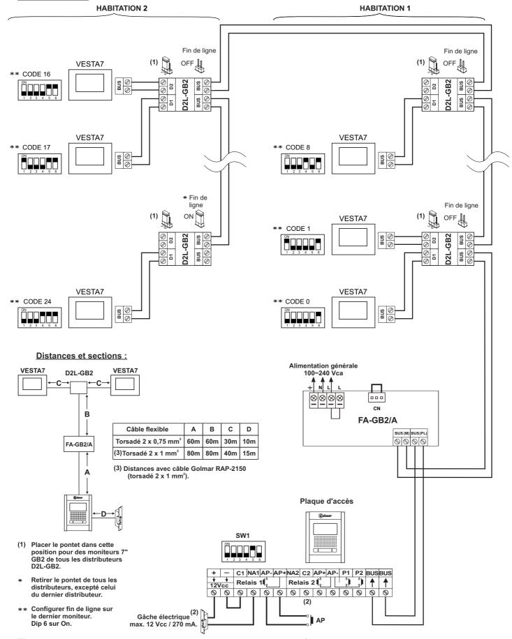
(2) Important : en ce qui concerne les gâches électriques de courant alternatif ou une 2° gâche électrique, se reportez au schéma « connexion de gâche électrique de courant continu et alternatif », page 19.
